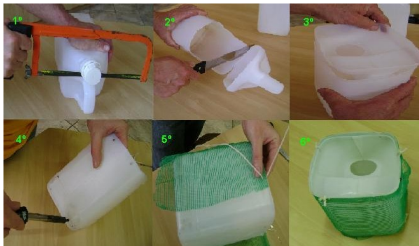
Figura 01 - Passo a passo da confecção das armadilhas, tipo “covo”, utilizadas na captura dos crustáceos
